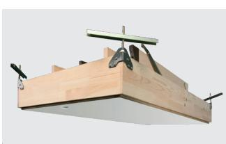
Montážní úhelníky zjednodušují a zefektivňují montáž schodů ve stropě. Namontované v rozích skříně využívají její konstrukci, zaručují zachování stejných délek uholopříček a také rychlé a přesné vyrovnání schodů ve stropě. Montáž ve stropě s max. tloušťkou 43 cm (pro schody LWT, LWT PH, LWF 60 a LMF 60), 39 cm pro schody LTK, LMP a 35 cm pro ostatní modely.
