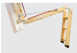
Odlehčující mechanismus napomáhá při skládání a rozkládání žebříku a zároveň zvyšuje pohodlí a bezpečnost používání půdních schodů. Pro 3dílné schody je určen mechanismus **LXM 3** a pro 4dílné schody mechanismus **LXM 4**. Lze jej použít u schodů instalovaných v místnostech s minimální světlou výškou 260 cm. Standardně se montuje na levé straně žebříku (naproti madla).
