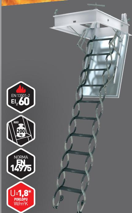
Protipožární stahovací schody **LSF** tvoří bariéru proti ohni uvnitř budovy a zamezují průniku ohně do požárem nezasazených prostor. Požární odolnost je **EI<sub>2</sub>=60 min** (klasifikace dle EN 13501-2), ze strany místnosti, ve které byly instalovány. Schody jsou určeny do obytných půdních prostor, kde není větší teplotní rozdíl jak 5 °C.
