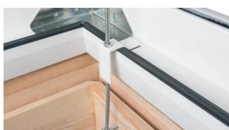
Montážní sada LXK-D usnadňuje a urychluje montáž půdních schodů LML Lux ve stropě, na kterém byl již namontován výlez na plochou střechu DRL. Montáž ve stropech s tloušťkou min. 38 cm a max. 50 cm.
