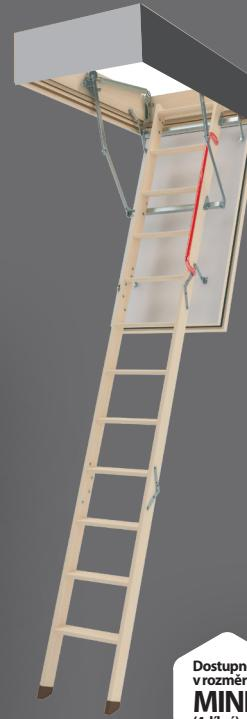
Schody **LWF 60** jsou novou generací protipožárních půdních schodů, které zaručují vysoký stupeň požární ochrany a také komfortní a bezpečný přístup do půdních prostor. Třída požární odolnosti schodů **LWF 60** je  $EI_1/EI_2 = 60 \text{ min}$  (klasifikace dle EN 13501-2), ze strany místnosti, ve které byly instalovány. Dostupné rovněž ve verzí se zámkem - **LWF 60 SL** (Security Lock).
