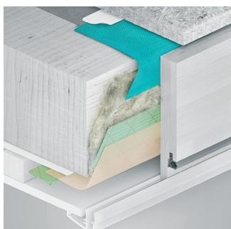
Izolační sada je určena k rychlému zateplení a utěsnění mezery mezi skříní namontovaných schodů a otvorem ve stropě. Použití sady zaručuje správné provedení tzv. „teplé montáže“, která je klíčová zvláště v nízkoenergetických stavbách. Součástí sady je parotěsný límec, termoizolační materiál z ovíjí vlny a paropropustný límec.
