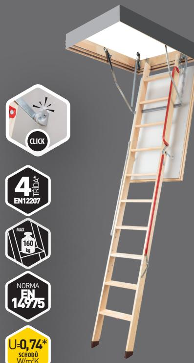
**LWL Extra** jsou půdní schody nové konstrukce se zvýšenými tepelně izolačními parametry. Pro zajištění větší bezpečnosti a pohodlí jsou dodatečně vybaveny madlem připevněným k prostřednímu dílu žebříku a speciálním mechanismem, který pomocí plynového pístu usnadňuje rozkládání a skládání žebříku.
