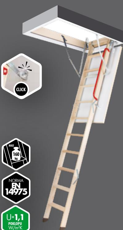
Půdní schody **LWZ Plus** spojují výhody nové konstrukce se systémem rychlé montáže. Ocelový rám, který využívá dřevěnou skříň, společně s integrovanými montážními uhlínkami a kovovými krycí lištami usnadňuje montáž a zkracuje čas potřebný k osazení schodů ve stropě.
