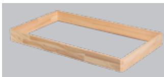
Nástavný rám z borovicového dřeva dokonale ladí se skříní namontovaných půdních schodů a umožňuje esteticky dohotovit stropní otvor. V případě stropů s tloušťkou větší než 31 cm, čtyřdílných skládacích schodů a stahovacích schodů LST a LSZ navíc slouží jako díl prodlužující výšku skříně, a umožňuje montáž horního krytu LXW. Standardní výška nástavného rámu je 10 cm; maximální atypická výška nástavného rámu je 16 cm pro schody LDK a 20 cm pro ostatní modely.
