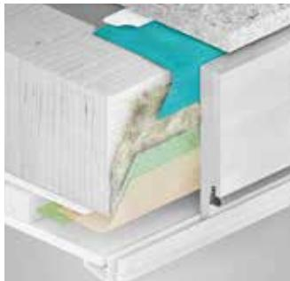
Izolační sada je určena k rychlému zateplení a utěsnění mezery mezi skříní namontovaných schodů a otvorem ve stropě. Použití sady zaručuje správné provedení tzv. „teplé montáže“, která je klíčová zvláště v nízkoenergetických stavbách. Součástí sady je parotěsný límec, termoizolační materiál z ovčí vlny a paropropustný límec.
