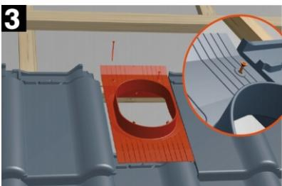
Spodní část základny (vzpěra) přišroubujte do střešní latě pomocí třech dlouhých šroubů (dva v horní části, jeden v dolní části). V případě potřeby lze spodní část základny dodatečně připevnit k lati (spodní řadě tašek) pomocí drátu z nerez oceli do připravených otvorů uvnitř základny.
