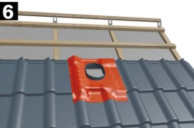
Vhodně vymodelujte Al límec (podle tašky) a pečlivě ho přilepte ke střešní krytině. Začíná se od středu základny směrem ke kraji základny. Důkladné přilepení se provádí pomocí střechařského válečku.
